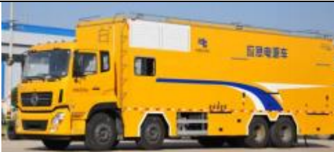
1000kW 中压应急电源车
