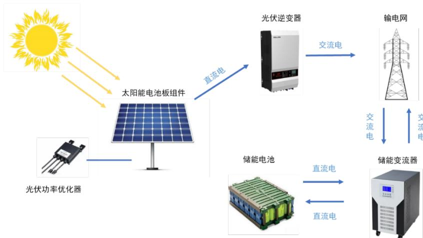
**光伏优化器：**光伏优化器也被称为光伏功率优化器，光伏功率优化器采用独特的软件算法，能实时追踪到单块组件的最大功率点（MPP, Maximum Power Point），用户可根据光伏系统的实际运行状况，选用不同类型的功率优化器，来解决因阴影遮挡、组件朝向差异或组件衰减不一致所造成的光伏系统发电量降低的问题，提升太阳能电池板组件的发电效率。
