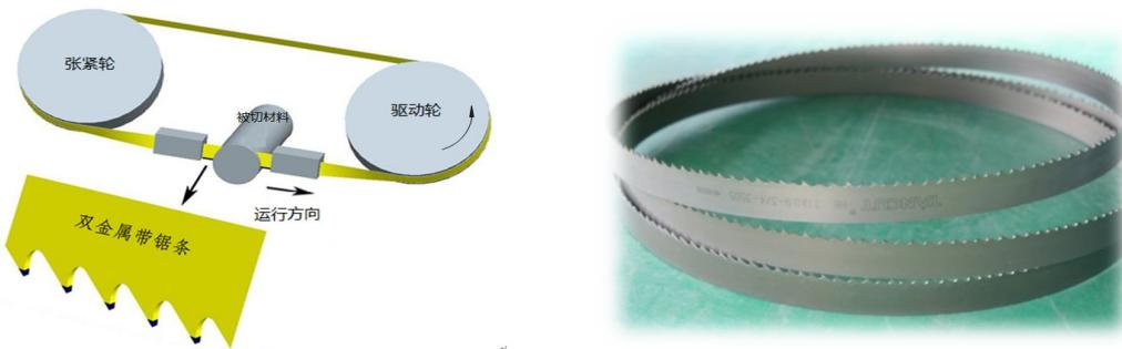
公司锯切业务主要产品为带锯条，带锯条是用一边开齿的连续钢带制成的环形钢带，是带锯床的消耗性刀具。在带锯床中，环形钢带被张紧在两个相距一定距离的锯轮上，随驱动轮单向循环传动进行切割。双金属带锯条是将两种不同特性的合金钢焊接在一起，再经机加工、热处理等一系列工艺制作而成的消耗性刀
