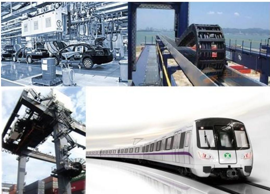
由于港口机械、大型自动化生产线和机器人、机车等设备，通常面临高强度机械应力、扭曲和弯曲应力以及户外作业的恶劣环境，故柔性电缆通常具备高柔性和耐油、耐磨损、耐紫外线、耐氧化、抗微生物，抗水解，抗撕裂等特殊性能。
