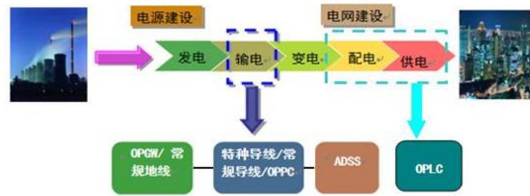
架空输电线路由输电导线、地线、电力光缆、杆塔、接地装置等部分组成。导线（又称为相线）主要承担传导电流的功能；地线（又称避雷线）主要用于防止架空线路遭受雷闪袭击，与接地装置共同起防雷作用；电力特种光缆系统是利用现有的输电线路杆塔资源建成的电力通信网络，主要包括 OPGW、OPPC、ADSS、OPLC 等。电力光缆中的光纤不仅仅提供话音、数据或视频传输等传统通信业务，还承担着电力调度、自动化、安全保护等重要任务，是保障现代输电系统安全可靠运行的“神经”。OPGW、ADSS、输电导线是建设智能电网的主要组成部分。
