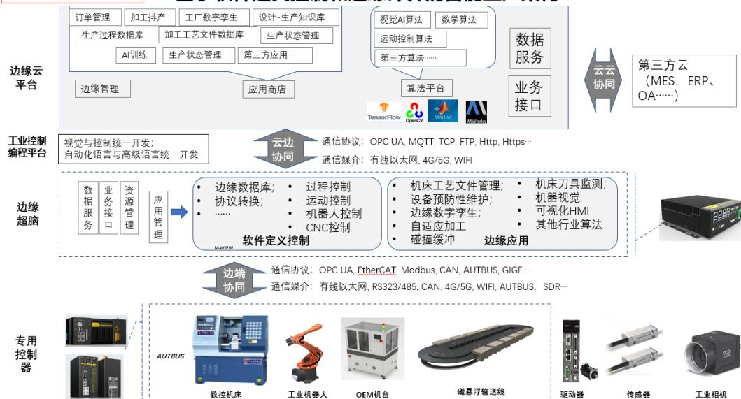
数字工厂智能控制解决方案项目将工业互联网“端、边、云”技术构架与工业制造领域相结合，设计并形成智能工业平台的系统架构，在此基础上开发平台各子系统。本项目将打造一个可以应用于多行业的边缘云平台，以支持接入工业生产线边缘侧设备，接入生产的数据，并为云上的其他第三方应用业务提供数据访问接口，应用承载环境各子系统。各子系统既能协同运作，也能独立运行，既能保证系统的整体性，也可分阶段循序推进。
