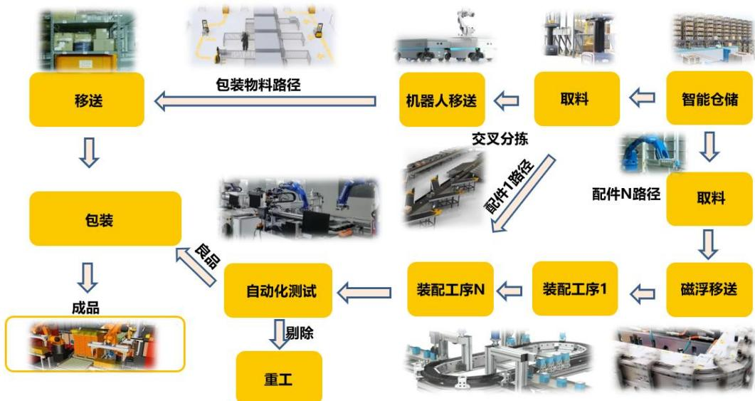
本示范线由智能物料仓储、智能物料输送、分拣、智能装配、自动化测试以及包装盒移送等模块组成，同时为了满足柔性场景，关键机台可以进行治具工装的多型适配。
