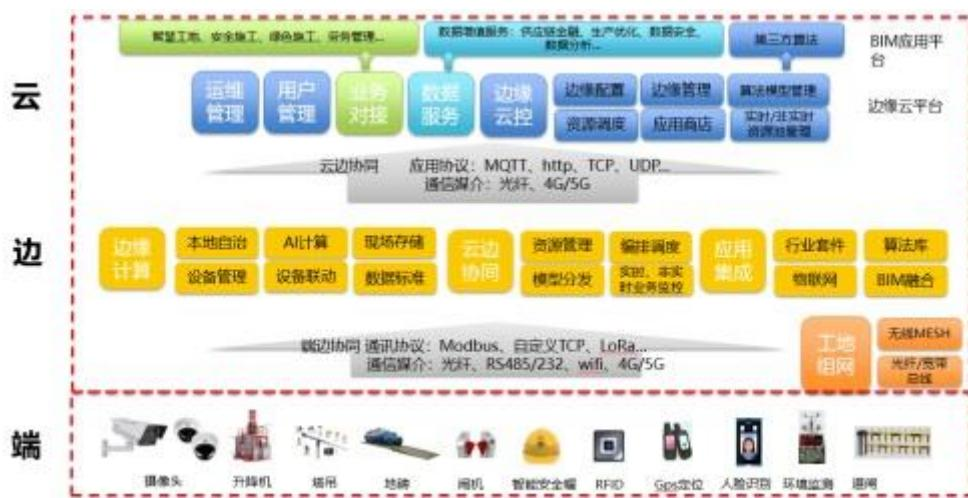
数字建造及智能工程装备控制解决方案纵向涉及企业本部与施工现场项目部的数据贯通，横向涉及施工现场各应用子系统的数据融合。围绕项目施工现场的监管要求，方案将工业互联网“端、边、云”技术构架与建造领域相结合，设计并形成数字工地平台的系统架构，在此基础上开发平台各子系统。各子系统既能协同运作，也能独立运行；既能保证系统的整体性，也可分阶段循序推进。
