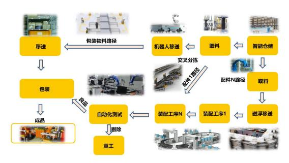
本示范线由智能物料仓储、智能物料输送、分拣、智能装配、自动化测试 以及包装盒移送等模块组成,同时为了满足柔性场景,关键机台可以进行治具 工装的多型适配。
