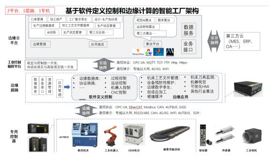
数字工厂智能控制解决方案项目将工业互联网"端、边、云"技术构架与工业制造领域相结合,设计并形成智能工业平台的系统架构,在此基础上开发平台各子系统。本项目将打造一个可以应用于多行业的边缘云平台,以支持接入工业生产线边缘侧设备,接入生产线的数据,并为云上的其他第三方应用业务提供数据访问接口,应用承载环境各子系统。各子系统既能协同运作,也能独立运行,既能保证系统的整体性,也可分阶段循序推进。
