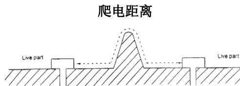
爬电距离指带电部件之间或带电部件与可接触表面之间沿绝缘体表面的最短距离。
