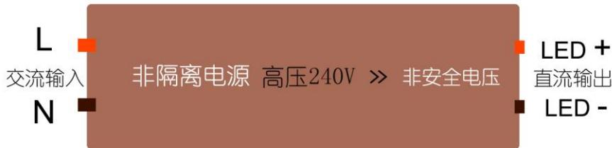
由上图可见，隔离电源、非隔离电源均是通过电气转换将交流电转换为直流电，而隔离电源经电子元器件转换后输出的是安全超低电压，而非隔离电源经电子元器件转换后输出的仍为非安全高压。
