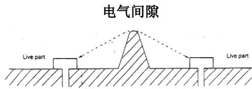
电气间隙指带电部件之间或带电部件与可接触表面之间的最短距离。
