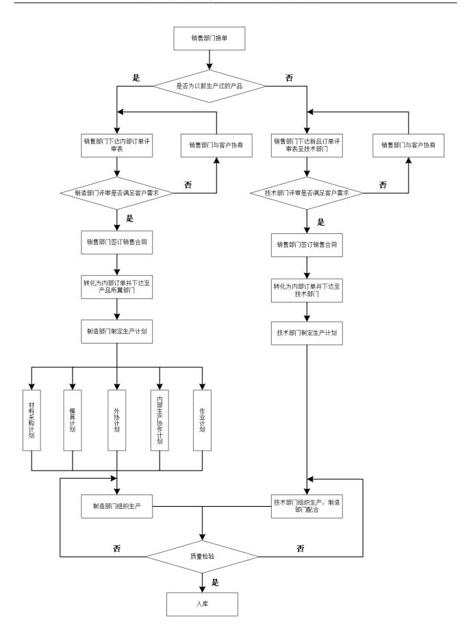
销售预测模式生产流程为:销售部门根据销售规划、市场预测分析,每月末下达下月及之后滚动半年的各产品种类销售预测计划至制造部门;制造部门根据销售预测计划,结合即时库存情况、年度最低及最高库存计划(每年初由制造部门编制)、总产能状况、已下订单占用产能情况等因素,编制月度产品生产计划,并制定材料采购计划、模具采购或生产计划、生产工艺准备计划、生产作业计划、外协计划等下达至相关部门,由制造部门组织生产,产品经质检合格后入库。
