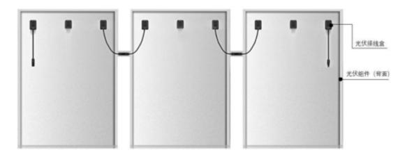
光伏接线盒产品主要由盒体、盒盖、自动保护器件、导电体、底座、连接器、电缆线等配件构成。光伏接线盒结构 图如下所示:
