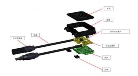
其中:①盒体、盒盖、底座等选用高分子材料通过注塑工艺生产制作而成,具备抗紫外线、耐热阻燃、抗老化等性能;②导电体采用高散热性,高导电性的金属材料通过冲压工艺生产制作而成,具备良好的散热性能和优异的导电性能;③自动保护器件具备在光伏组件发生热斑效应时起到自动保护功能,所谓热斑效应指在太阳能组件的构造中,单个电池片被串联在一起,若其中一个电池片被遮挡,受影响的电池将不再作为电源工作,而是变为能量消耗者,其他未遮挡的电池板将继续通过它们传递电流造成较高的能量损耗,此时热斑效应就会出现,甚至可能产生电池损毁。为了解决这个问题,自动保护器件能自动工作起到保护作用,旁路电流绕过遮挡的电池片,经自动保护器件传递下去;④线缆、连接器作为光伏接线盒的通用配件,主要作用为连接光伏组件并传导其产生的电流。
