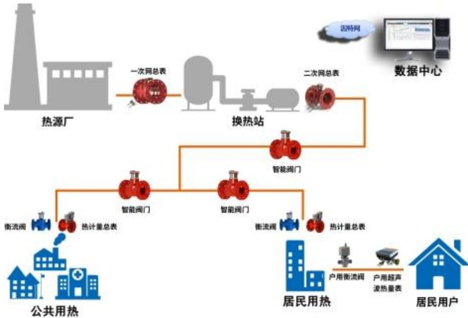
公司智能超声热表类产品包括超声热量表、智能控制阀和智能衡流阀等产品，其中超声热量表为主要产品。超声热量表采用超声波流体测量原理，通过换能器和温度传感器提供流量和温度信号，经过密度和热焓值补偿及积分计算得出热量值，进而测量及显示水流经热交换系统所释放或吸收热量。公司智能超声热表类产品主要应用于北方集中供暖市场。
