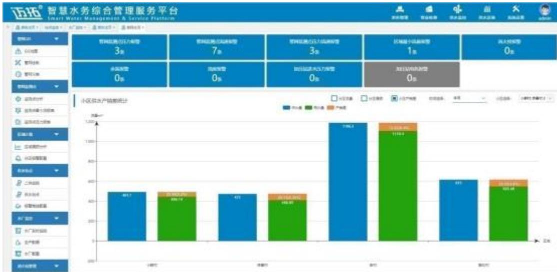
供水运维系统主要用于为供水企业的日常运营管理提供支持，主要包括工单系统和巡线管理系统两部分：工单系统可以通过报警信息或自主创建工单并分派任务给员工并进行全程跟踪；巡线管理系统为管道巡查工作提供实时监控，从而更有效的对管道巡查工作进行管理。软件控制界面如下：
