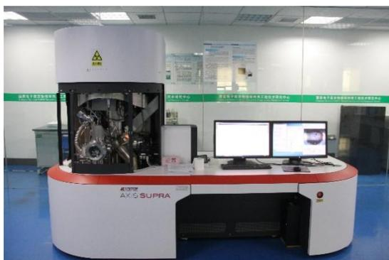
X 射线光电子能谱仪
