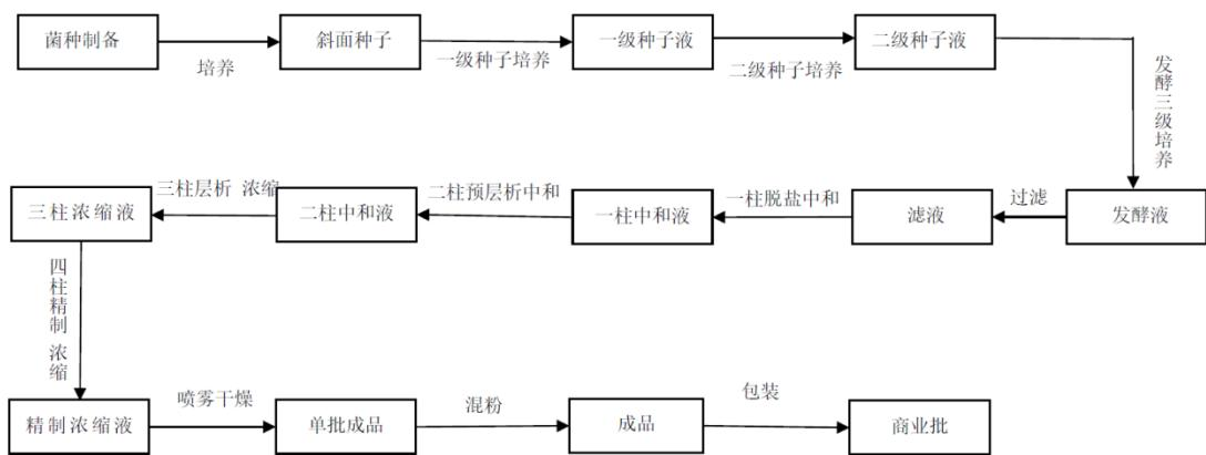
按照前述流程图,阿卡波糖的主要生产环节可概括为种子制备环节、发酵环节和提取精制环节等三大环节,其中种子制备环节对应工艺流程图中的“菌种制备”到“二级种子液”,发酵环节对应工艺流程图中的“二级种子液”到“发酵液”,提取精制环节对应工艺流程图中的“发酵液”到“精制浓缩液”。种子制备环节主要是对发酵菌种进行筛选和培育,使其生长为适合发酵的状态,发酵环节主要是为游动放线菌发酵创造出适合的环境和条件,使其发酵生产出阿卡波糖,提取精制环节主要是将生产出的阿卡波糖提取出来,去除其他杂质,获得质量达标的阿卡波糖,也称为产物的分离纯化。
