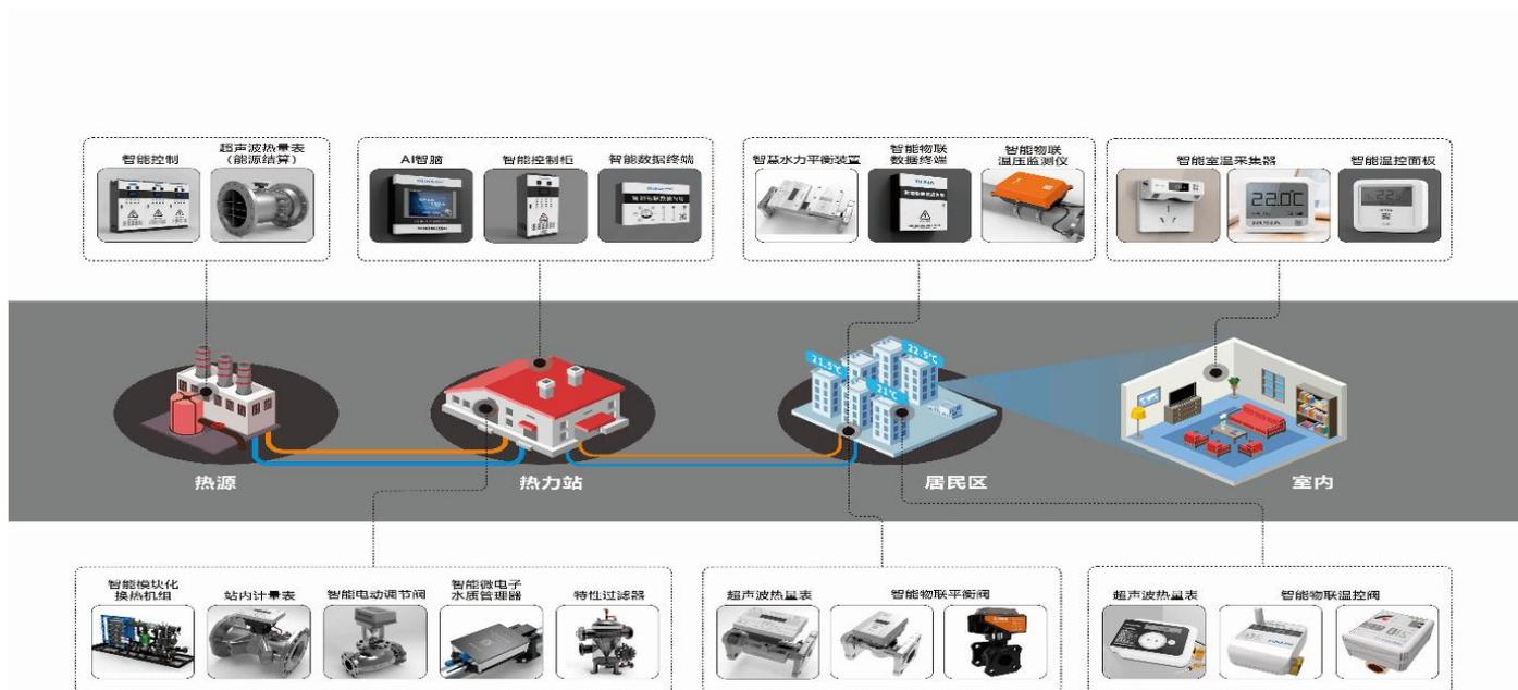
(1) 公司自主研发生产的能源智能控制设备主要包括模块化换热机组、智能控制柜、智能平衡阀、STORM AI 控制器等，主要用于供热系统管网自动化用热控制、温度调控。公司模块化换热机组与智能控制柜等配套产品可组合成智能模块化换热机组；公司智能平衡阀与楼栋超声波热量表等产品可组合成智能水力平衡装置。
