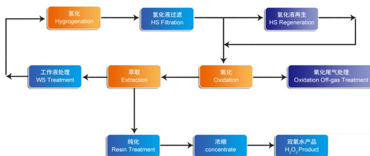
采用流化床工艺，在触媒存在下，将溶于有机溶剂中的烷基蒽醌氢化，得到相应的烷基氢蒽醌，后者再经氧化，即生成过氧化氢。同时烷基氢蒽醌又变回烷基蒽醌。生成的过氧化氢用纯水萃取，即得产品，萃余的烷基蒽醌溶液经处理后，可循环使用。
