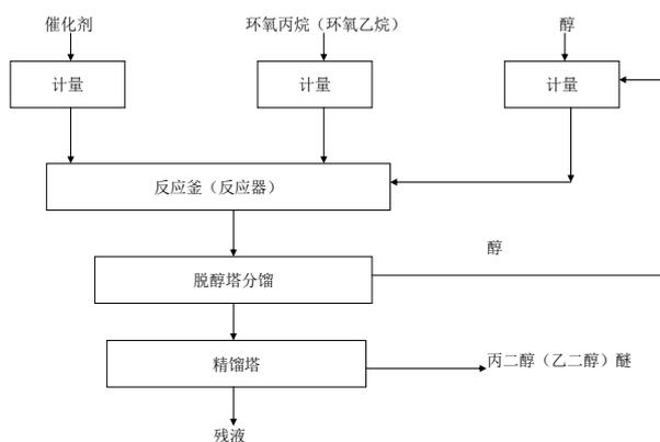
原料EO或PO、醇、催化剂按工艺要求经计量，经过充分混合后，经预热进入反应釜（器）进行醚化反应，反应结束后反应液进入脱醇塔回收原料醇，釜液进入多段精馏塔精馏出丙二醇（乙二醇）醚。
