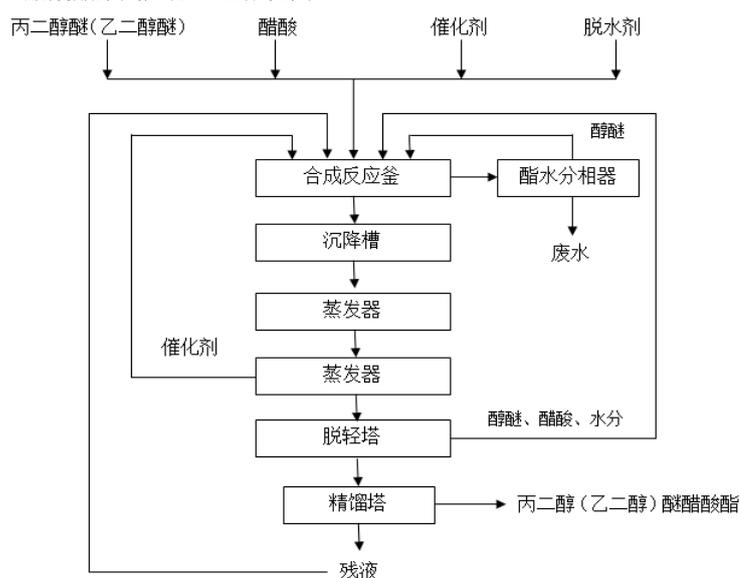
原料醚、醋酸、脱水剂、催化剂按工艺要求经计量加入反应釜中反应，反应产生的水经脱水塔的脱水剂从塔顶采出废水，经酯水分相器，上层脱水剂回反应系统，下层废水经废水处理系统处理至达标后排放。反应液合格后经沉降槽沉降，上层清液进入脱轻塔减压精馏分离出中间组分回用，釜液进入精馏塔精馏出合格产品。残液富含催化剂回反应釜循环使用。
