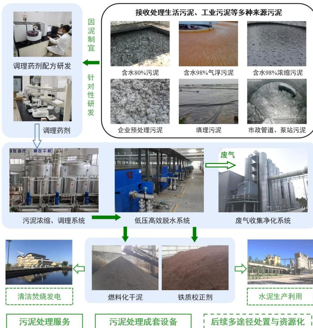
公司的污泥处理服务系接收城市、工业等污水处理厂产生的含水率 98%左
