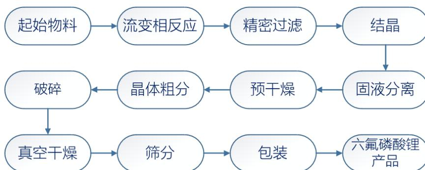
六氟磷酸锂产品生产需要经历合成、结晶和精烘包三个重要工序，起始物料至精密过滤为合成工序，结晶至晶体粗分统称为结晶工序，结晶后再经破碎、真空干燥、筛分、包装等工序后制成产成品。精烘包工序主要指破碎、干燥、筛分，需要在成品车间完成，同时反应过程中产生的废酸需要在废酸车间进行处理。
