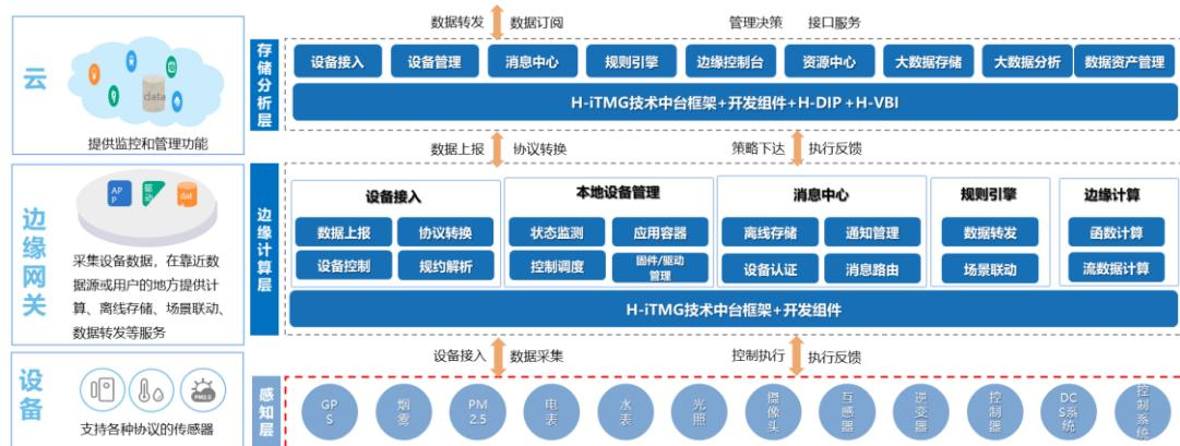
虚拟电厂数据监控构件集能够支撑物联网终端数据接入、数据建模、实施存贮、分析展示、告警处理，智能远程计量、分析与控制以及历史数据管理。
