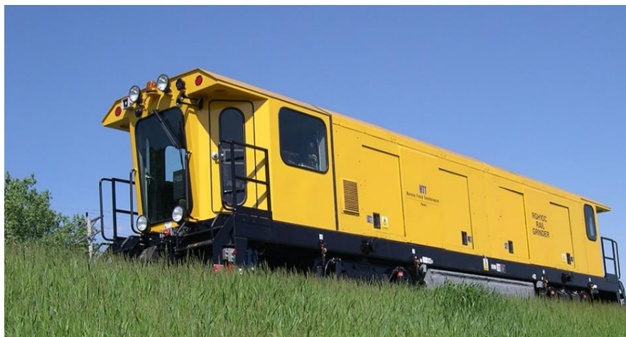
图 3-15 哈斯科轨道几何状态检测车
