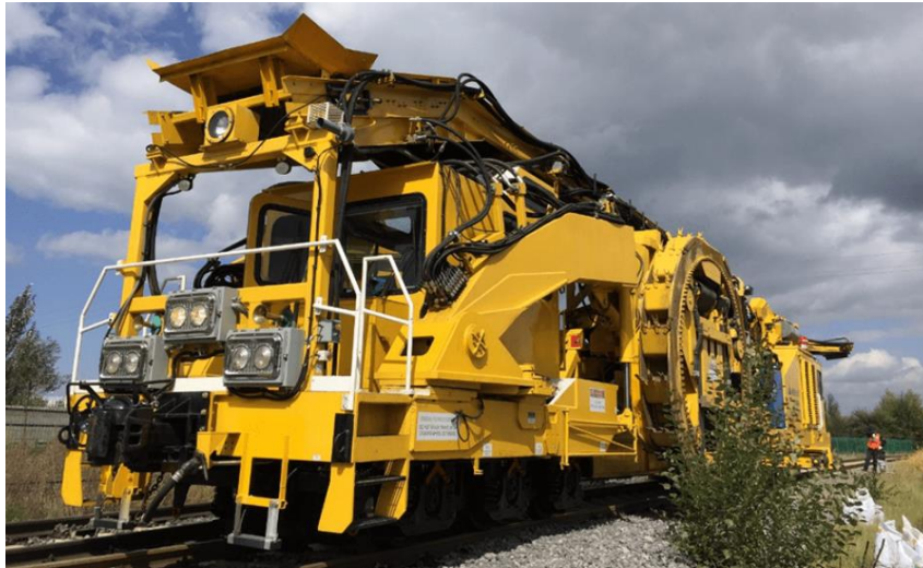
图 3-16 哈斯科 G04S-III-CN 型道岔清筛车
