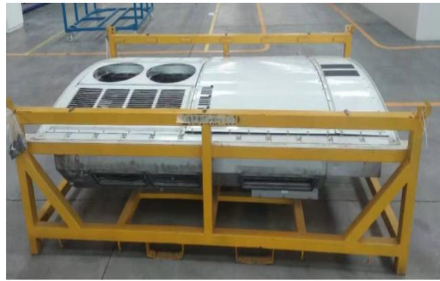
图 3-12 CRH1 平台动车组空调检修产品
