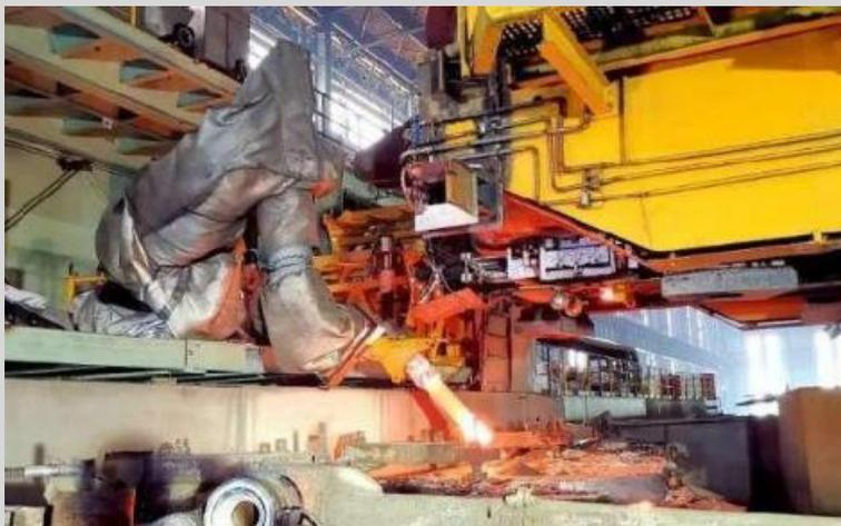
炼钢厂 7 号连铸机工业机器人
