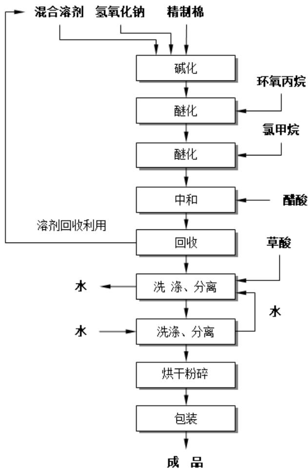
③气相法建材级HPMC生产流程
