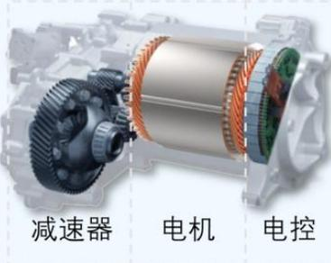
减速器 电机 电控
