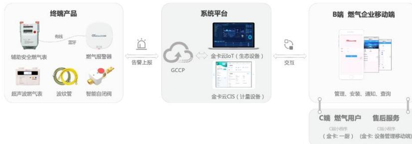
工商业燃气安全解决方案精准赋能餐饮企业、工商业用户、大型综合体等场所燃气安全管理，方案配置独立式工商业燃气报警器、系统式报警器、紧急切断阀等智能终端设备，对工商业用气环境进行监管和预警提醒，同时结合金卡智能的辅助安全燃气表、智能流量计，实现安全管控。政府部门、燃气公司通过 IoT 平台，实时监测用气工况，安全管控，有效降低燃气爆燃、爆炸事故风险隐患。
