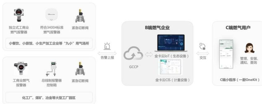
管网安全监测解决方案通过对调压设备、管网压力监测点、重要商户等进行压力、流量等参数的定时监测，同时集成 GIS、SCADA、巡检、安检工单等系统，实现对管网设备用气环境进行远程诊断、精准预警，一旦出现异常情况，快速定位与解决异常问题。同时为政府、燃气公司和社会公众提供数据共享与交换、管控与决策支
