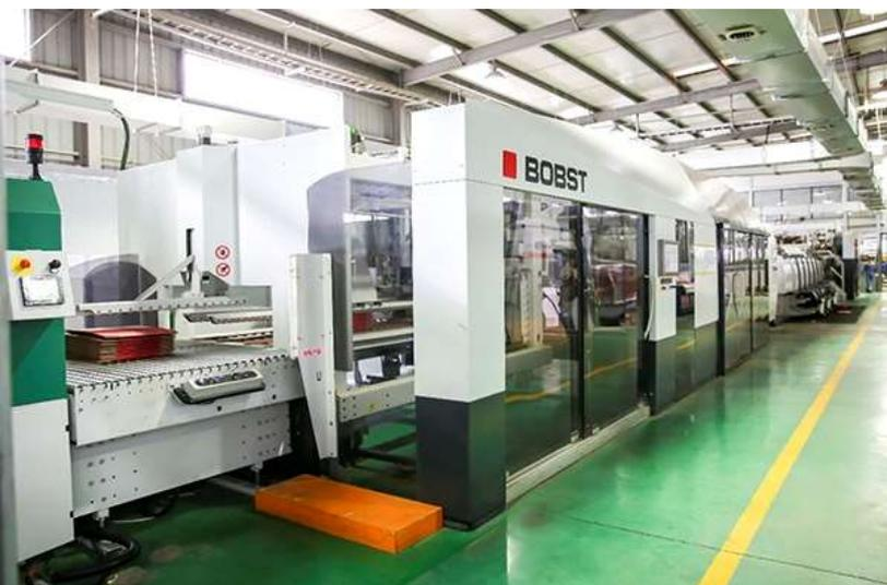
公司拥有从德国引进的先进瓦楞纸板生产流水线，从法国引进的五色柔印制箱联动线，使生产自动化控制得到全面、有效的提高。法国 BOBST（博斯特）FFG 8.20 全自动纸箱联动线，生产速度可达 24000 个纸箱/小时，只需 3 人就能轻松操作机器，是国内首条该型号纸箱联动生产线。
