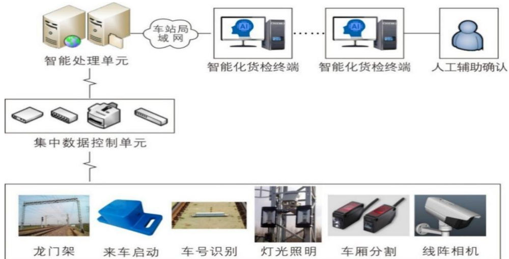
图 11：货车装载状态高清智能检测系统
