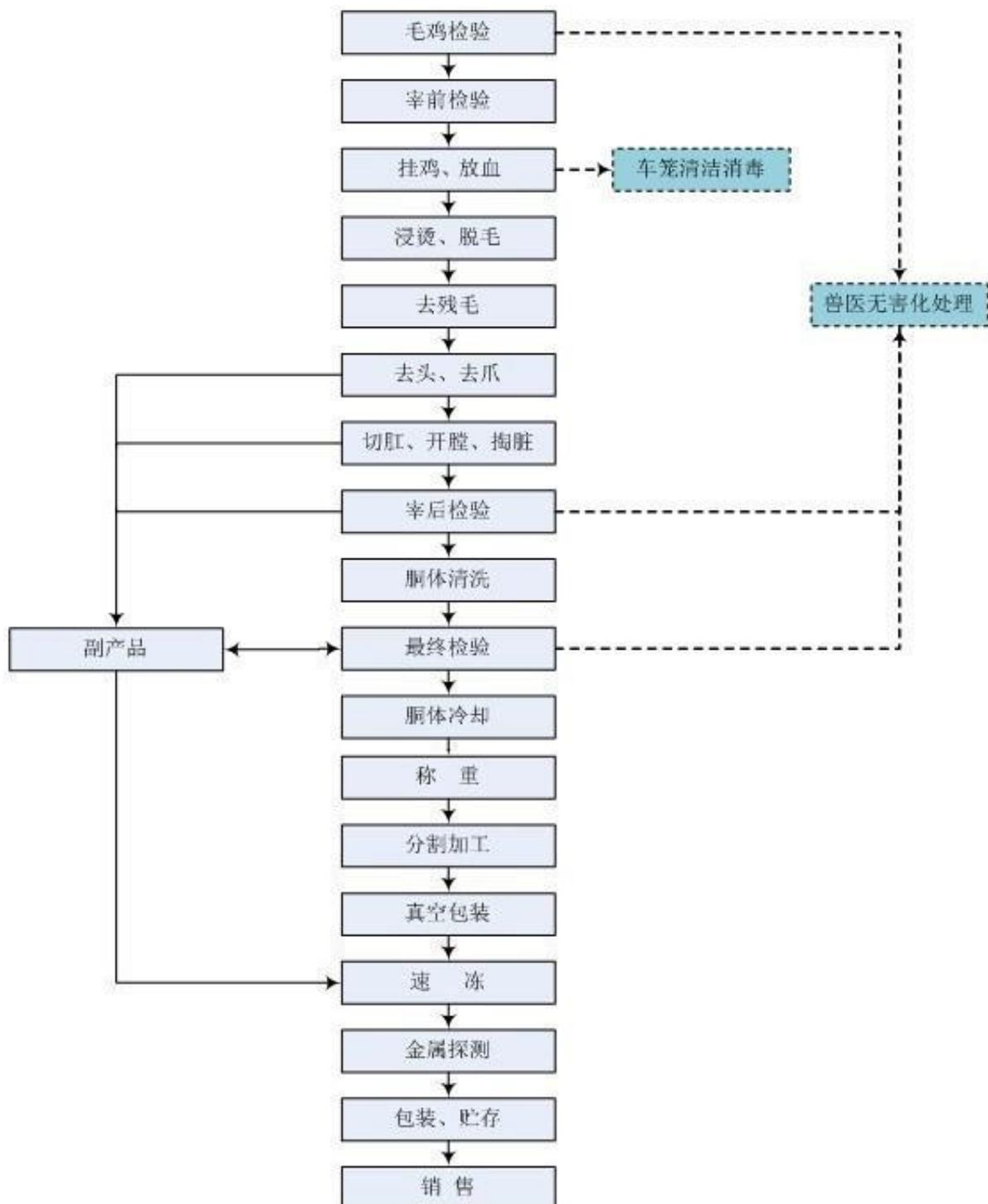
肉鸡屠宰及加工业务由子公司民和食品经营，拥有世界领先的荷兰斯托克和荷兰梅恩肉鸡屠宰加工生产线。掏脏采用全自动的方式，设备配有高压清洗系统，从而避免了员工工作时的交叉感染。加工中通过多道“关卡”的检验及宰后同步检验检疫，严格保证了鸡肉产品的质量。
