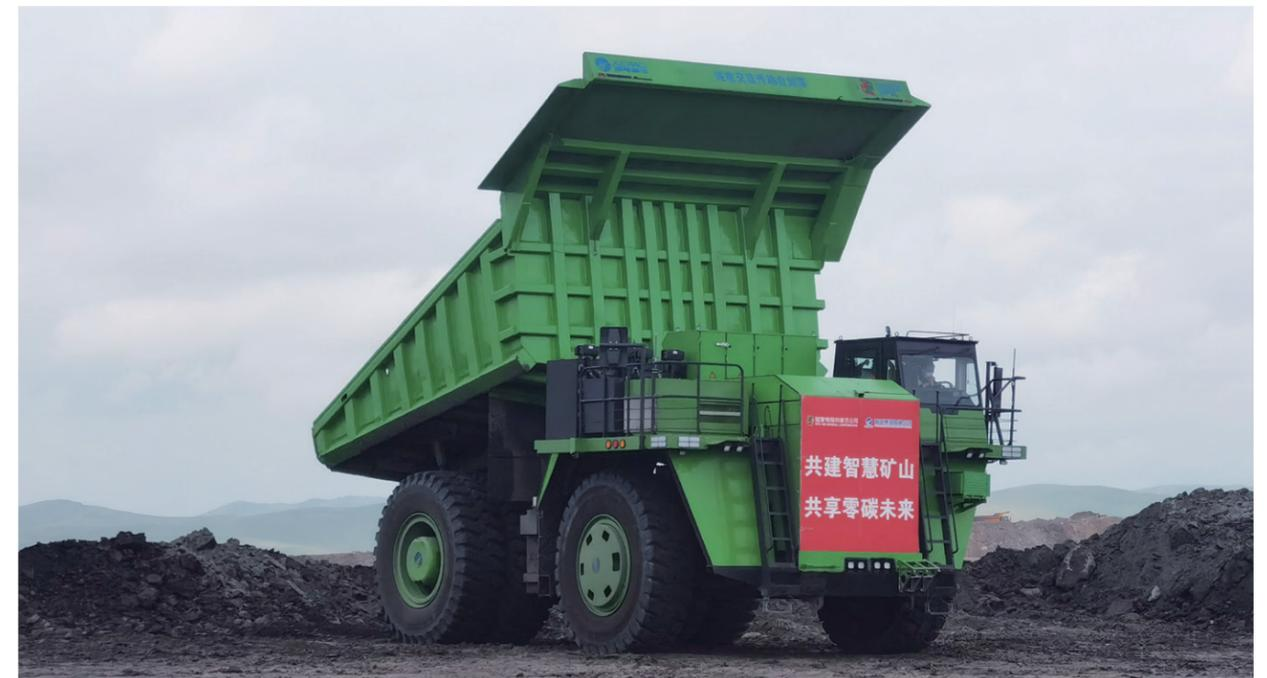
世界首台 120 吨级纯电动交流传动矿用电动轮自卸车投入运行，推动实现矿山运输设备清洁化作业
