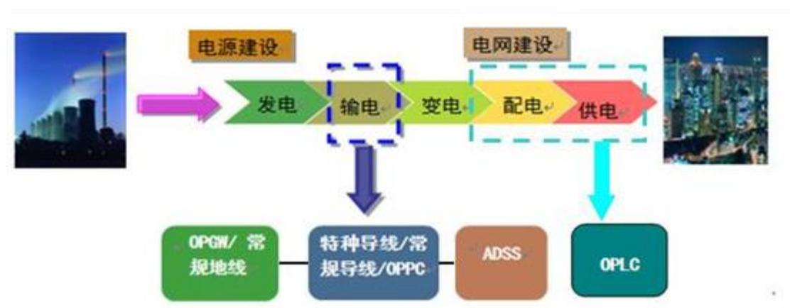
架空输电线路由输电导线、地线、电力光缆、杆塔、接地装置等部分组成。导线（又称为相线）主要承担传导电流的功能；地线（又称避雷线）主要用于防止架空线路遭受雷闪袭击，与接地装置共同起防雷作用；电力特种光缆系统是利用现有的输电线路杆塔资源建成的电力通信网络，主要包括 OPGW、OPPC、ADSS、OPLC 等。电力光缆中的光纤不仅仅提供话音、数据或视频传输等传统通信业务，还承担着电力调度、自动化、安全保护等重要任务，是保障现代输电系统安全可靠运行的“神经”。OPGW、ADSS、输电导线是建设智能电网的主要组成部分。
