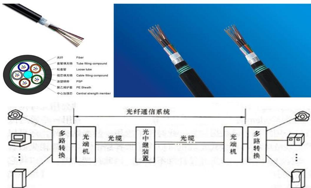
通信光缆可用于通信、广电、电力、铁路等行业的通信线路，可架空、管道、直埋敷设。
