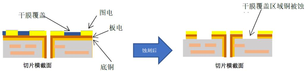
蚀刻液将覆铜板及铜箔表面多余的铜蚀刻后产生含铜蚀刻废液，以板电负片法工艺为例，双面板及多层板蚀刻前后对比如下：
