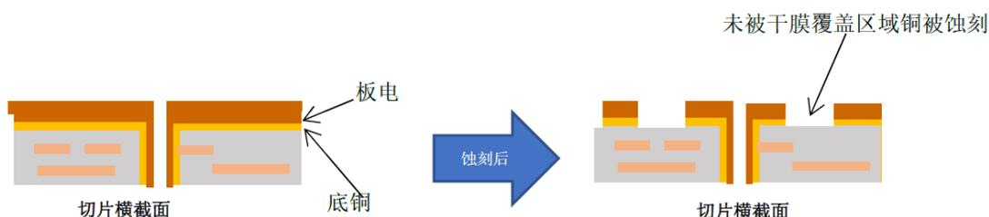
图电正片法工艺：使用干膜覆盖的生产工艺，将不需要线路的区域使用干膜覆盖，覆盖干膜的区域在图电被阻挡无法电镀铜，未覆盖干膜的区域图电后会增加铜和锡作保护，蚀刻时将干膜位置的铜蚀刻掉，其余位置的铜（图电加厚的）保留在板上。
