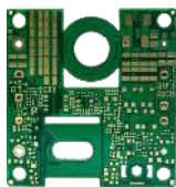
14层厚铜板/光伏逆变器
