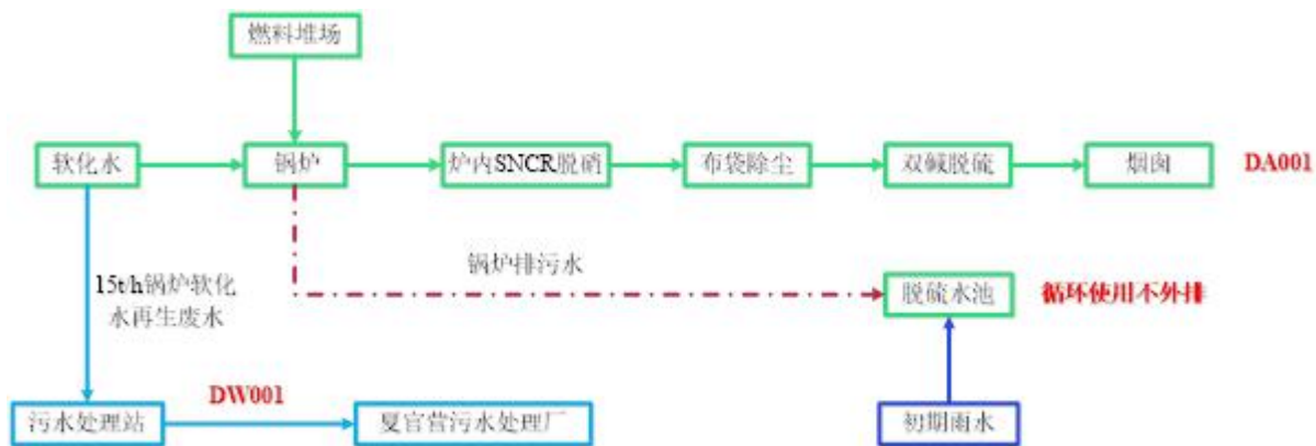
图1-2 锅炉生产工艺流程及产污节点图
