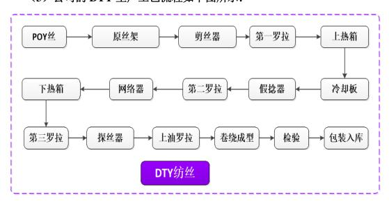
公司DTY系列产品主要以自产的POY为原料,在加弹机上进行拉伸、经假捻器变形加工后形成的成品丝。报告期内,公司主要产品的生产工艺未发生明显变化。
