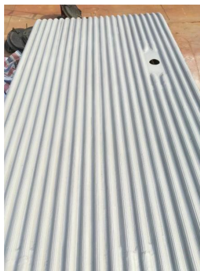
图2 HCMT冷焊加工后的管排
