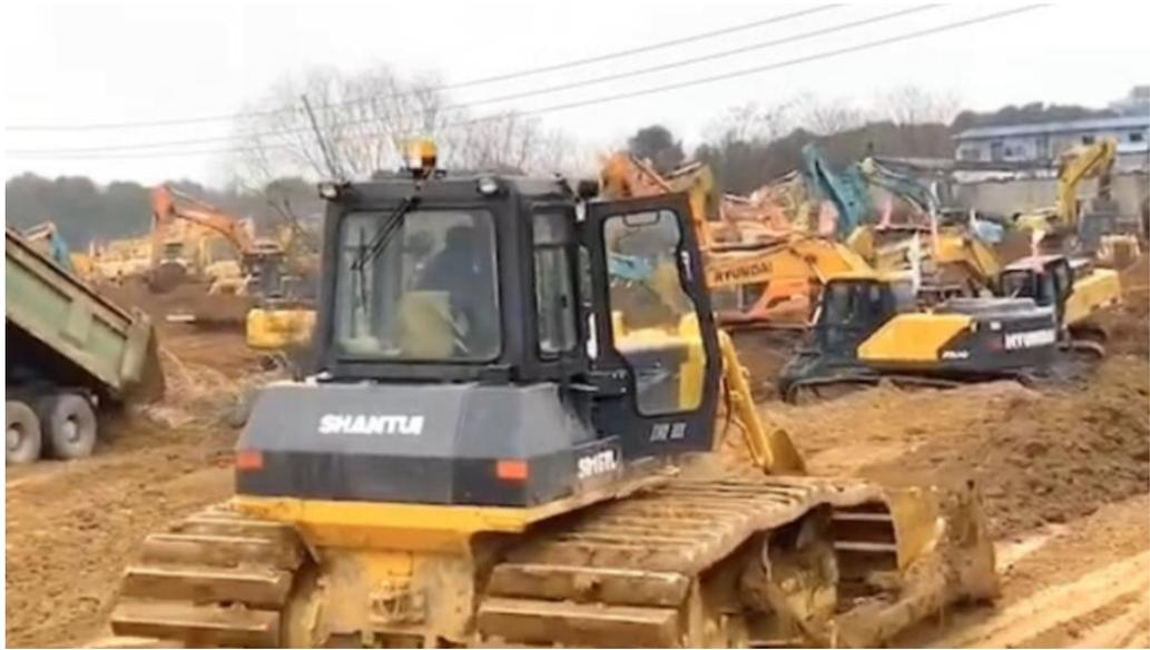
• 2月12日，为应对即将到来的开工季，山推根据疫情防控的需要，推出了全面升级的“正压版”全液压推土机，DH17C2和DH24C2全系列均可加装，它的防护级别甚至超过N95口罩的95%@0.3 $\mu$ m，达到99.9%的专业级防护。
