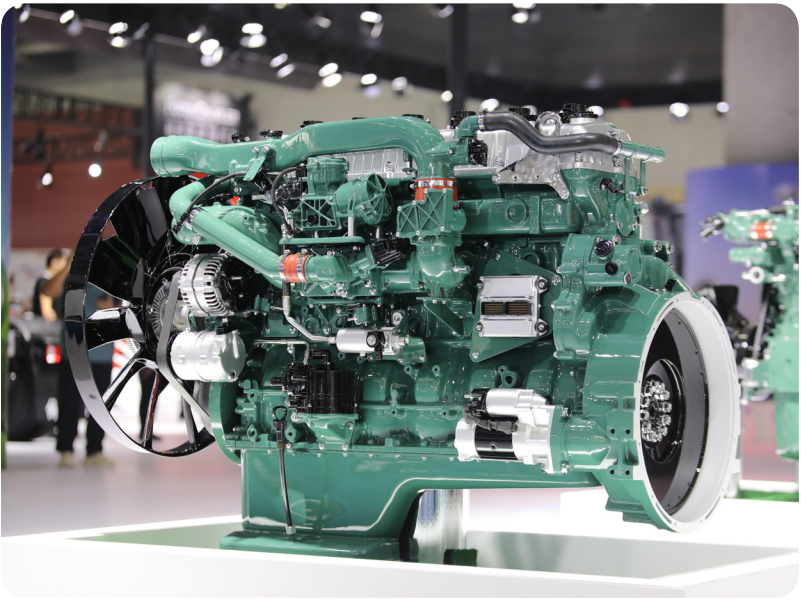
▲ 采用超低排放技术的解放动力奥威CA6DM3发动机，该技术NO x 加权排放0.018g/kWh，低于全球最严苛排放法规要求33%。该发动机成功通过塞浦路斯交通部审核，成为国内首个获得欧VI-e排放认证的发动机，取得进军欧洲市场的“入门证”
