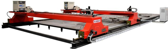
智能化盖梁骨架焊接生产线解决了当前公路、桥梁等工程盖梁骨架焊接施工劳动强度大、安全风险高等问题，通过工业化流水线的方式进行钢筋网片生产，对钢筋网片进行整体折弯成型，采用钢筋部品装配化方式帮助实现塔柱节段拼装，通过融合装配化、自动化、信息化技术，实现了超高桥塔钢筋部品装配化施工。整个系统实现智能化控制，操作人员可通过触摸屏对所加工钢筋骨架片图形进行编辑。该设备的研发有利于加工我国各种平面钢筋部品生产，提高工程质量，缩减工程工期。同时，该智能化生产线焊接配有智能视觉焊缝跟踪系统，毫秒级别数据采集响应，精准确定焊缝三维位置，从而高质焊接。
