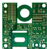
14层厚铜板/光伏逆变器
