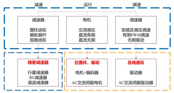
公司每年投入大量的研发费用用于产品技术的升级迭代和前沿技术创新:精密减速器方面,公司具备精密减速器力学仿真、传动误差仿真、寿命仿真等正向设计能力,齿轮及金属结构件等精密零部件的热处理、制造,以及整机产品的寿命、传动链误差、温升、传动效率等检测评价能力; 电机方面,公司具备冲片、绕线、定子封装、充磁等全工序加工能力,有限元电磁仿真、热仿真等设计能力,
