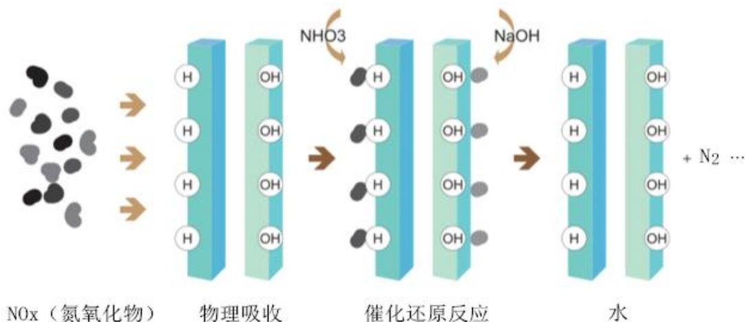
与其他脱硝技术相比，公司自主研发的低温液态催化脱硝技术具有脱硝效率高、投资成本和运行成本双低、无二次污染等突出优势，兼具可远程中央操控、占用空间小，操作简单、运行安全等特点。传统固态重金属催化剂一般最佳工作温度在 320-400 摄氏度，在此温度下的脱硝效率最高在 85% 左右，低于此温度，催化剂效率将大幅降低，高于此温度，催化剂将可能失效，催化剂效率还会随着使用时间递减，定期更换后的催化剂属于危险固废，易造成二次污染。在公司制程污染防控设备应用的泛半导体、精细化工以及汽车制造等精密制造业领域，氮氧化物排放一般为常温，且该领域对氮氧化物污染浓度指标控制极为严苛，传统催化剂较低的脱硝效率基本无法有效处理；在公司末端污染治理设备应用的钢铁、水泥行业，氮氧化物排放温度一般在一百多摄氏度，需要将排放气体升温至 300 摄氏度以上，传统催化剂方可有效工作，相比公司的专有催化剂配方，势必导致投资成本和运营成本的增加。
