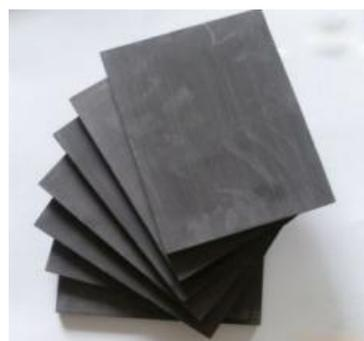
特种石墨材料具有高强度、高密度、高纯度、化学稳定性高、导热和导电率高、耐高温、耐辐射、润滑性强和易加工等特点。
