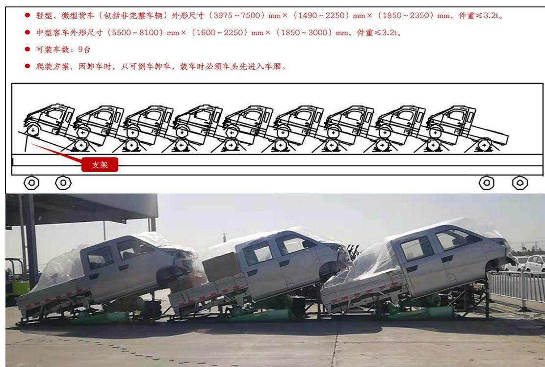
针对车辆不同重量和装载要求，设计对应的加固方案，如下图所示：
