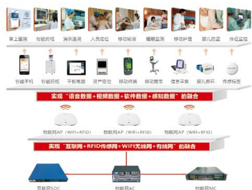
多网合一的物联网基础架构平台
