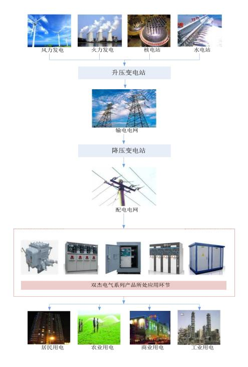
输电网是电力系统中最高压等级的电网,是电力系统中的主要网络(简称主网)。配电网分一次配电网、二次配电网,其中一次配电网是从配电变电所到配电变电所入口之间的网络,称为高压配电网络;二次配电网络是由配电变压器次级引出线到用户入户线之间的线路、元件所组成的系统,又称低压配电网络。公司的产品主要应用于一次配电网络。
