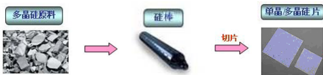
图 3-16 太阳能级单晶硅片生产过程图
