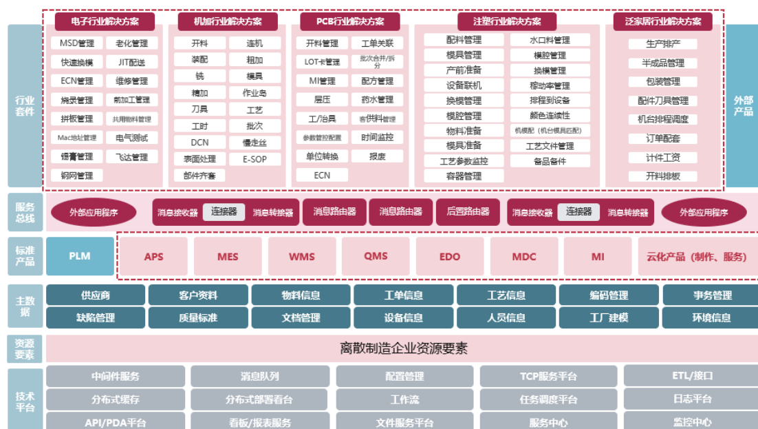
SMOM智能制造套件整体架构图
