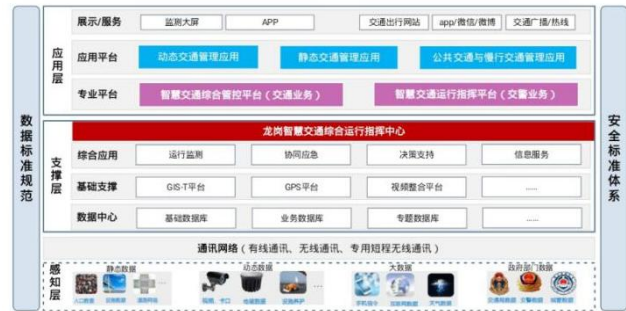
图2-2 智慧交通体系逻辑架构图
