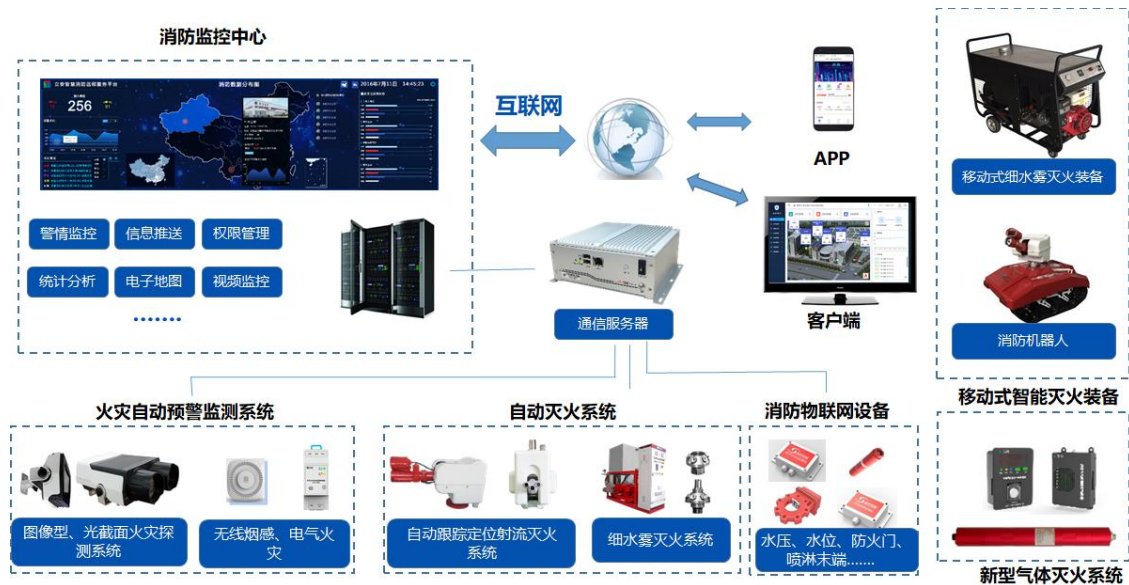
图4：消防安全系统示意图
