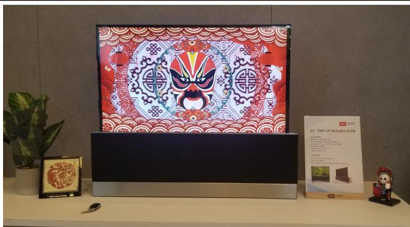
31 英寸喷墨打印可卷绕柔性样机
