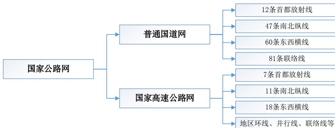
**普通国道：**将由10.6万公里增加到26.5万公里，增加1倍多。普通国道网由12条首都放射线、47条南北纵线、60条东西横线和81条联络线组成。
