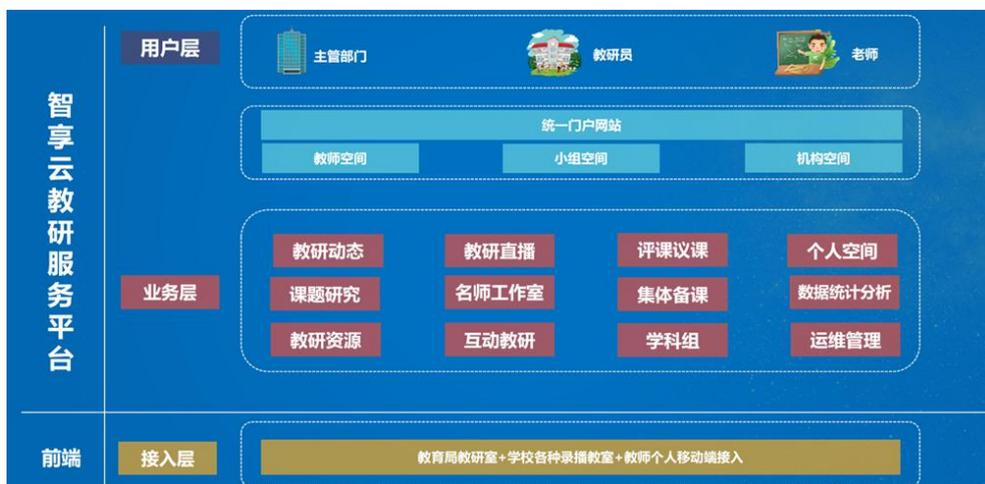
智慧教育行业产品体系作为公司云视频赋能垂直行业的重要应用，以“云+网+端”为基础，通过业界领先的SVC柔性云视频平台、AI教育云终端，以及结构化视频管理系统等技术，实现教育视频资源的接入，同时可通过中间件服务实现各种第三方教育、教学管理应用的无缝接入，形成真正的可实时视频互动的K12双师课堂方案。在教育信息化1.0时代，传统的录播课堂只能解决课堂视频本地存储，直播课堂又只能提供高延时的视频单向传输；而教育信息化2.0的到来，开启了将云视频大规模实时互动的技术应用于双师教学的时代，SVC柔性云视频的超低延时技术，极大的提高了老师和学生视频交流的临场感。
