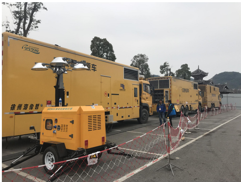
500kW 发电车黔东南春晚保电工作场景
