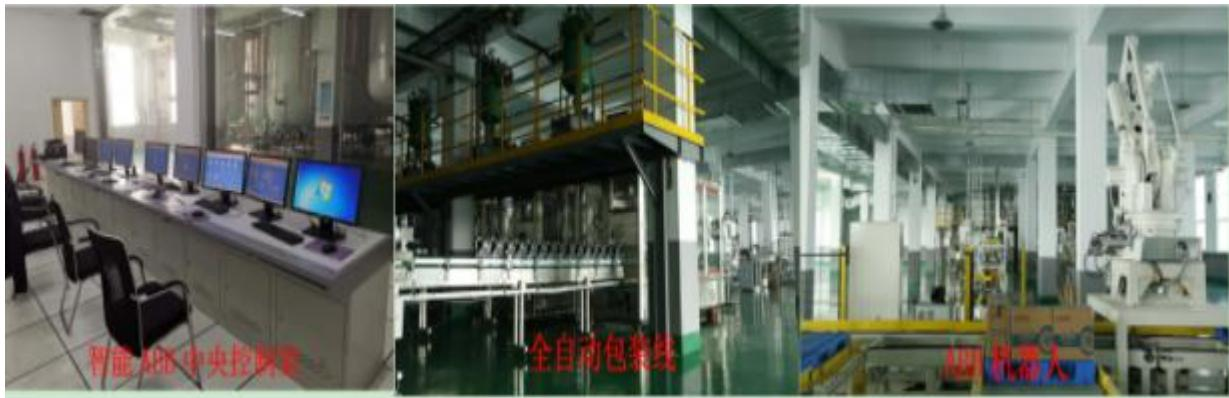
生产过程采用SMB、ABB、DDU、球扫系统，实现油品的自动输送、泵自动测控和油品的自动调和，同时还采用国内较先进的脉冲搅拌技术，实现基础油的边输送边混合，大大提高基础油在生产过程中的稳定性和能耗；先进的二维码技术、在线检重、在线检漏技术在灌装技术中得到了充分的利用，在灌装生产线上，采用二维码分拣技术，分拣正确率达到了100%。在包装灌装上，采用ABB机器人进行码垛，保证中小包装生产线的高效节能运行。从而在整个生产过程中构建全过程自动批量生产集成控制。有效满足了市场对个性化润滑油产品的需求，提升了公司产品的竞争实力。
